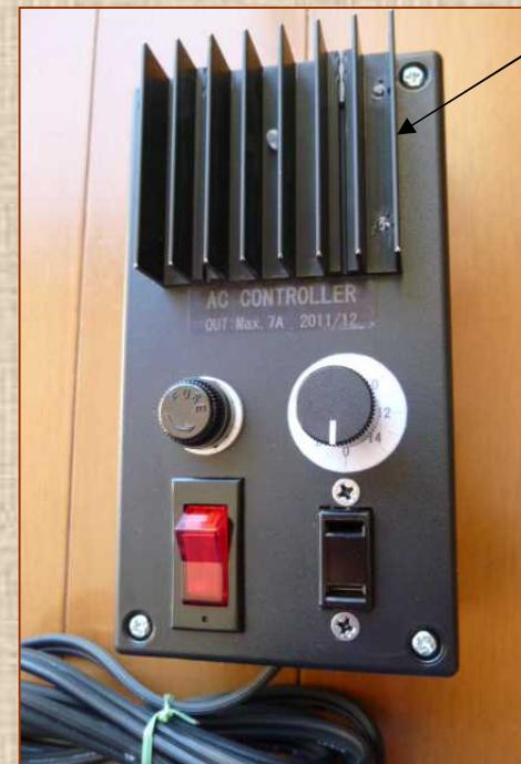
ヒートシンクを内部に収納した場合、放熱穴の処理が面倒なので、先輩達のアイデアを拝借して、外付けにしてみた。
